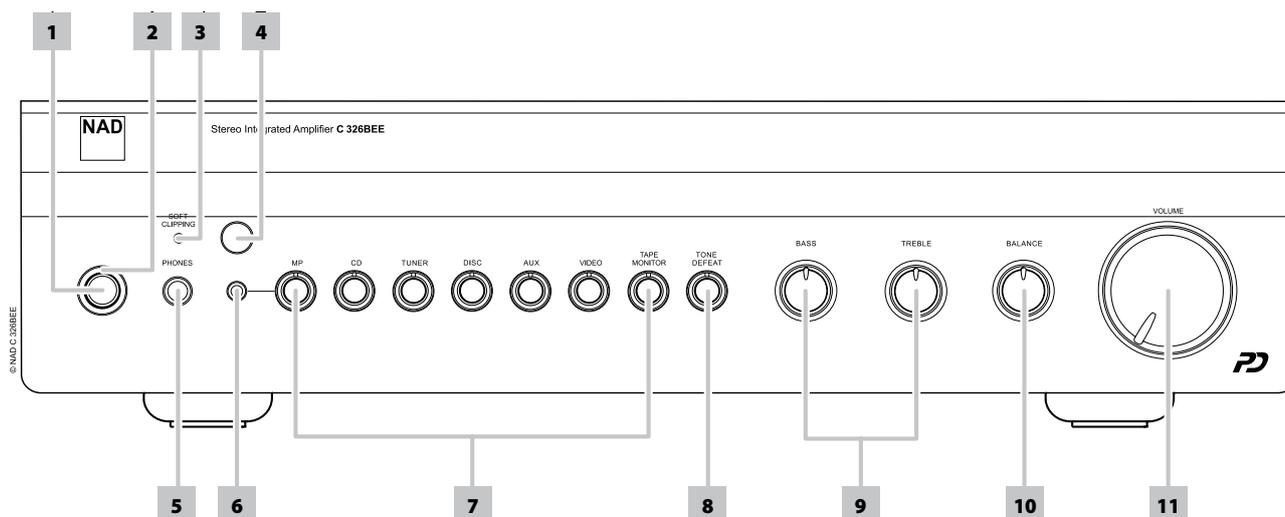
**1 MISE EN VEILLE :** avec l'interrupteur POWER (Alimentation) du panneau arrière en position ON (Marche), appuyez sur cette touche pour annuler le mode Veille sur le NAD C 326BEE. Le voyant à LED Standby (Veille) passe de la couleur jaune à la couleur bleue. Une nouvelle pression sur ce bouton fait repasser l'appareil en mode Standby (Veille).
