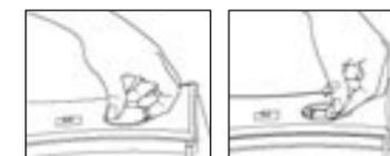
Open het batterijdekseltje op de achterkant van de weegschaal. Plaats de nieuwe batterij zoals aangegeven.
