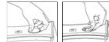
Abra la tapa del compartimiento de la pila, situado en la parte trasera de la plataforma de pesaje. Inserte la pila nueva según se indica en la figura.
