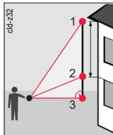
Déterminer la hauteur entre point 1 et 2 à l'aide de 3 points de mesure.
