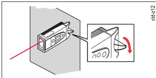
☞ Tourner le pied rotatif de 90° pour un appui plan et stable (uniquement pour le Disto classic<sup>4</sup>).
