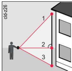
Détermination à l'aide de 3 points de mesure.
