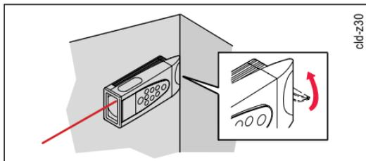
☞ Le DISTO lite<sup>4</sup> ne permet pas d'effectuer de mesures précises dans un coin.
