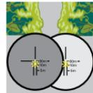
4. Utiliser les deux vis (réglage latéral, en hauteur) pour ajuster le point laser.
