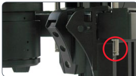
Position de montage trop haute
