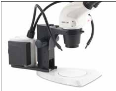
Double col de cygne procurant une flexibilité totale pour éclairer des échantillons complexes.
