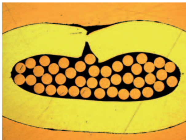
Prise de vue d'un sertissage
