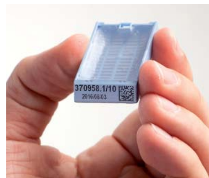
Cassette Leica LP C après infiltration des tissus et enrobage d'un échantillon
