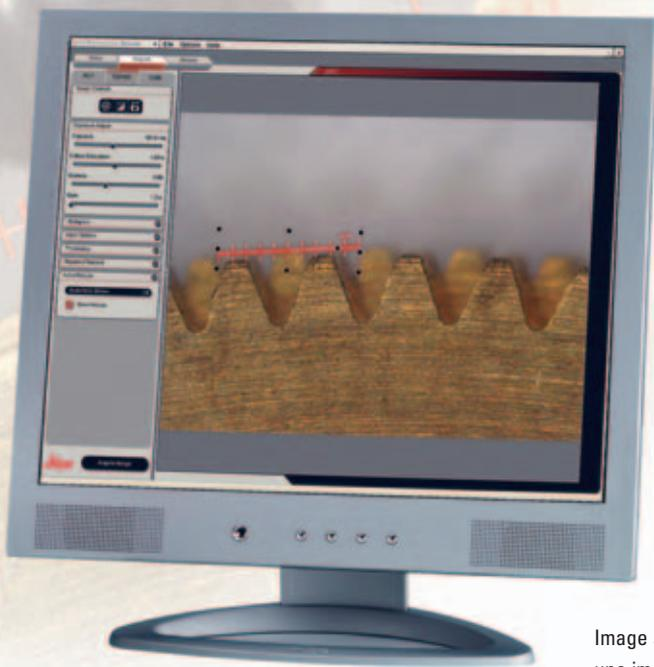
Image sur moniteur: réticule sur une image d'un engrenage obtenue avec un stéréomicroscope motorisé Leica MZ16 A et une caméra numérique Leica
