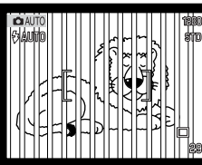
Deux sujets situés à des distances différentes se superposent dans la zone AF.
