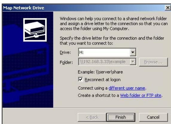
Alternativamente (ad esempio da un altro computer che non abbia NDU installato) aprire Windows Explorer e digitare due back slash seguiti dal nome sistema o indirizzo IP dell'NSA.
