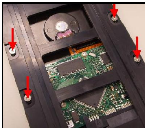
Schéma 6. Renforcer le disque dur sur le panneau en utilisant les vis fournies
