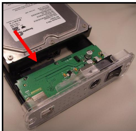
Schéma 5. Connecter le disque dur SATA vers l'adaptateur SATA
