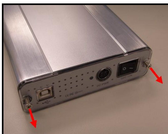
Schéma 2. Enlever les vis de la partie supérieure
