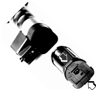
Bild 4a: Batterie-bzw. Akku auswechseln
