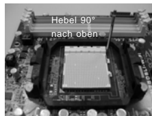
SCHRITT 1: Ziehen Sie den Sockelhebel hoch
