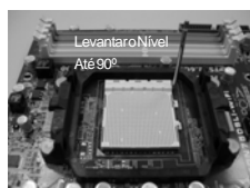
PASSO 1: Levantar o Nível de Tomada Até 90°
