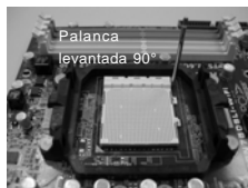
PASO 1: Levante la Palanca del Zócalo
