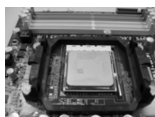
步骤 4： 下推并锁住插座拉杆
