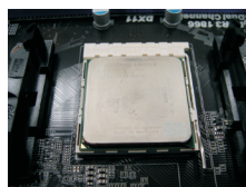
ШАГ 4. Прижмите и зафиксируйте рычаг гнезда.
