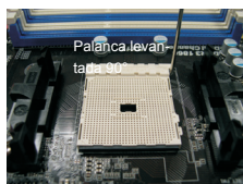
PASO 1: Levante la Palanca del Zócalo
