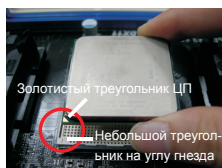
ШАГ 2, ШАГ 3. Совместите золотистый треугольник ЦП с небольшим треугольником на гнезде.
