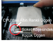
ADIM 2 / ADIM 3: CPU'daki Altın Renkli Üçgeni Soket Köşesindeki Küçük Üçgenle Eşleştirin
