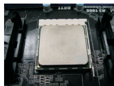
步驟 4： 下推並鎖住插座拉桿
