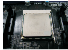
步骤 4: 下推并锁住插座拉杆
