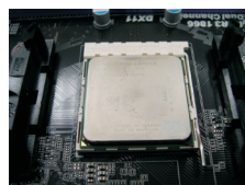
PASO 4: Apretete Hacia Abajo y Bloquee La Palanca del Zócalo
