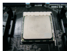
FASE 4: Abbassare e bloccare la levetta socket
