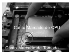
PASSO 2/PASSO 3: Apropria o Canto Marcado de CPU ao Canto Marcado de Tomada
