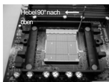
SCHRITT 1: Ziehen Sie den Sockelhebel hoch
