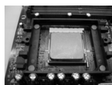
FASE 4: Abbassare e bloccare la levetta socket
