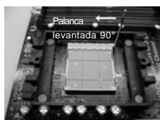
PASO 1: Levante la Palanca del Zócalo
