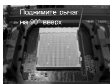
ШАГ 1. Поднимите рычаг гнезда.
