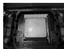
ШАГ 4. Прижмите и зафиксируйте рычаг гнезда.
