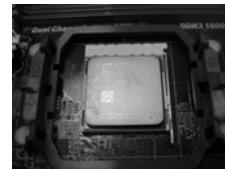
步骤 4: 下推并锁住插座拉杆
