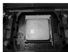
FASE 4: Abbassare e bloccare la levetta socket
