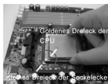
SCHRITT 2 / SCHRITT 3: Richten Sie das goldene Dreieck der CPU mit dem kleinen Dreieck der Sockellecke aus
