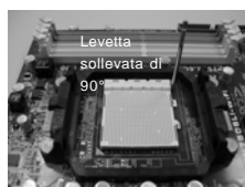
FASE 1: Sollevare la levetta socket
