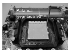
PASO 1: Levante la Palanca del Zócalo
