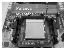
PASO 1: Levante la Palanca del Zócalo
