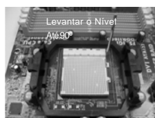
PASSO 1: Levantar o Nível de Tomada Até 90°
