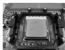
FASE 4: Abbassare e bloccare la levetta socket
