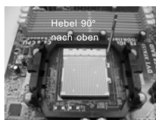
SCHRITT 1: Ziehen Sie den Sockelhebel hoch
