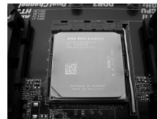
步驟4： 下推並鎖住插座拉桿
