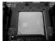
ШАГ 4. Прижмите и зафиксируйте рычаг гнезда.
