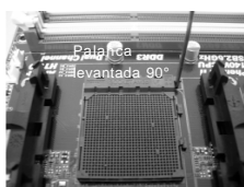
PASO 1: Levante la Palanca del Zócalo
