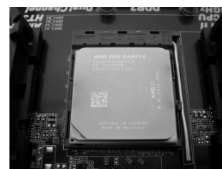
FASE 4: Abbassare e bloccare la levetta socket
