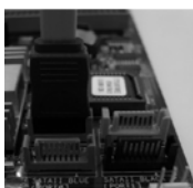
Connectez le câble de données SATA au connecteur SATAII rouge (SATAII_RED (rouge) (PORT2))
