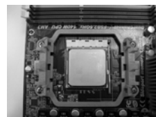
步驟4： 下推並鎖住插座拉桿
