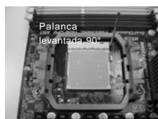
PASO 1: Levante la Palanca del Zócalo
