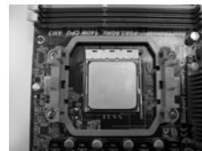
步驟 4： 下推並鎖住插座拉桿
