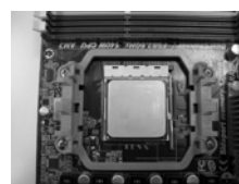
FASE 4: Abbassare e bloccare la levetta socket
