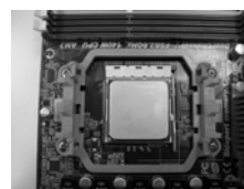
FASE 4: Abbassare e bloccare la levetta socket
