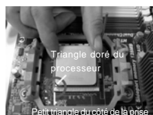
ETAPE 2/ETAPE 3 : Mettez le triangle doré du processeur sur le petit triangle du côté de la prise
