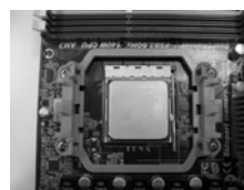
步骤 4： 下推并锁住插座拉杆
