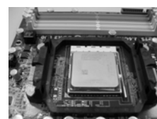
FASE 4: Abbassare e bloccare la levetta socket
