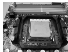
ステップ 4 ソケットレバーを押し下げてロックします
