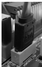
Collegare il cavo dati SATA al connettore eSATAII (eSATAII_TOP)
