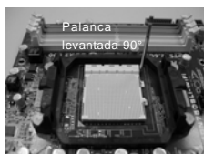
PASO 1: Levante la Palanca del Zócalo
