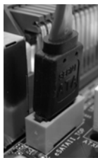
SATAデータケーブルをeSATAIIコネクタ(eSATAII_TOP)に接続します
