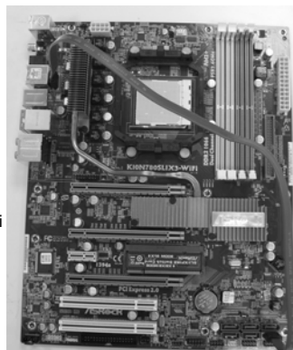
Collegare il cavo dati SATA al connettore eSATAII (eSATAII_TOP)
