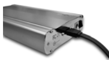
eSATAII デバイスケーブルの一方の端を eSATAII デバイスに接続します
