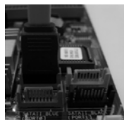
将 SATA 数据线连接到 红色的 SATAII 接口 (SATAII_RED (PORT2))
