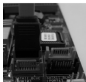
Collegare il cavo dati SATA al connettore SATAII rosso (SATAII_RED(rossa) (PORT2))
