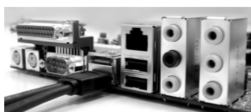
将 eSATAII 设备连线的另一端连接到 I/O 挡板的 eSATAII 设备
