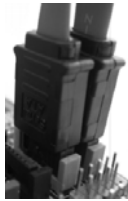
Conecte los cables de datos SATA al conector SATAII rojo (SATAII_RED (rojo) (PORT 1)) y el conector anaranjado SATAII (SATAII_ORANGE (anaranjado) (PORT 2))
