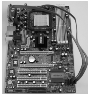
Conecte el cable de datos SATA al conector rojo eSATAII (eSATAII_BOTTOM) y el conector anaranjado eSATAII (eSATAII_TOP)
