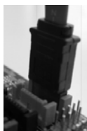
Collegare il cavo dati SATA al connettore SATAII rosso (SATAII_ RED(rossa) (PORT 1))
