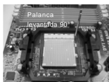
PASO 1: Levante la Palanca del Zócalo
