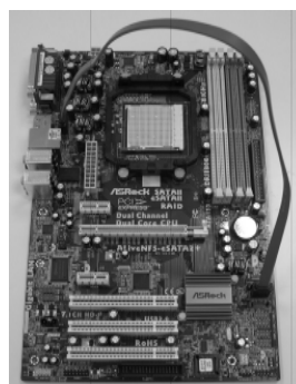
SATAデータケーブルを赤いeSATAIIコネクタ(eSATAII_BOTTOM)に接続します
