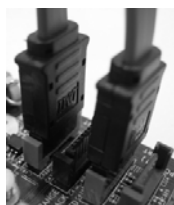
SATAデータケーブルを赤いSATAIIコネクタ(SATAII_RED(PORT1))とオレンジのSATAIIコネクタ(SATAII_ORANGE(PORT3))の両方に接続します
