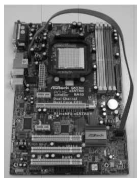
Collegare il cavo dati SATA al connettore eSATAII rosso (eSATAII_BOTTOM)
