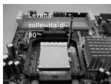
FASE 1: Sollevare la levetta socket
