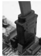
Schließen Sie das SATA-Datenkabel an den roten SATAII- Anschluss (SATAII _RED(PORT1)) an.
