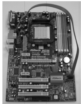
将 SATA 数据线连接到红色的 eSATAII 接口 (SATAII_BOTTOM)
