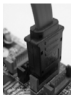
Collegare il cavo dati SATA al connettore SATAII rosso (SATAII_RED (PORT1))
