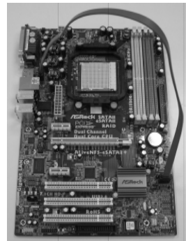
Verbinden Sie das SATA-Datenkabel mit dem roten eSATAII- Anschluss (eSATAII_BOTTOM).
