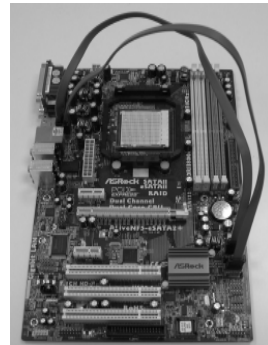
将 SATA 数据线连接到红色的 eSATAII 接口 (SATAII_BOTTOM) 和橙色的 eSATAII 接口 (SATAII_TOP)
