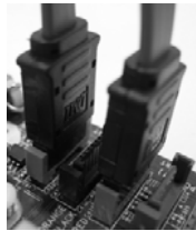
将 SATA 数据线连接到红色的 SATAII 接口 (SATAII_RED (PORT1)) 和橙色的 SATAII 接口 (SATAII_ORANGE (PORT3))
