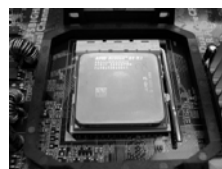
步骤 4： 下推并锁住插座拉杆
