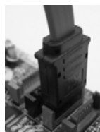
SATAデータケーブルを赤いSATAIIコネクタ(SATAII_RED(PORT1))に接続します
