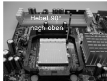
SCHRITT 1: Ziehen Sie den Sockelhebel hoch
