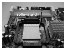
FASE 1: Sollevare la levetta socket
