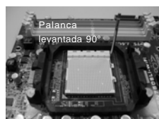
PASO 1: Levante la Palanca del Zócalo
