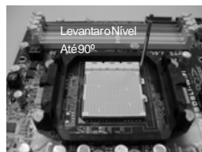
PASSO 1: Levantar o Nível de Tomada Até 90°
