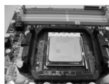
FASE 4: Abbassare e bloccare la levetta socket
