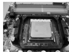
步驟 4： 下推並鎖住插座拉桿
