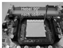
SCHRITT 1: Ziehen Sie den Sockelhebel hoch
