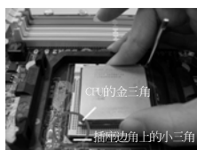
步骤 2 / 步骤 3: 将 CPU 的金三角对准插座 边上的小三角
