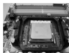
FASE 4: Abbassare e bloccare la levetta socket
