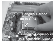
PASO 2 / PASO 3: Encaje el Triángulo Dorado de la CPU Con el Triángulo Pequeño de la Esquina del Zócalo
