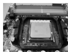
FASE 4: Abbassare e bloccare la levetta socket
