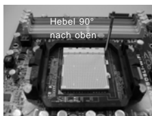
SCHRITT 1: Ziehen Sie den Sockelhebel hoch
