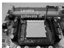
FASE 1: Sollevare la levetta socket
