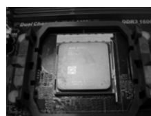
FASE 4: Abbassare e bloccare la levetta socket
