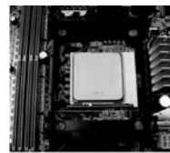
SCHRITT 4: Drücken Sie den Sockelhebel nach unten und rasten Sie ihn ein
