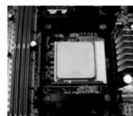
FASE 4: Abbassare e bloccare la levetta socket
