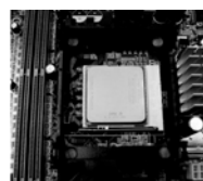
PASO 4: Apriete Hacia Abajo y Bloquee La Palanca del Zócalo
