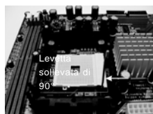
FASE 1: Sollevare la levetta socket
