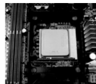
步骤 4： 下推并锁住插座拉杆
