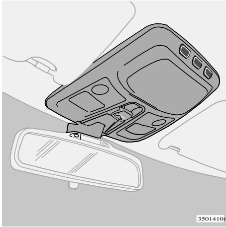
Eclairage général et liseuses avant
