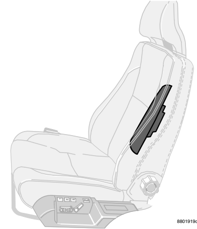
Les airbags latéraux sont logés dans le cadre des dossiers des sièges avant
