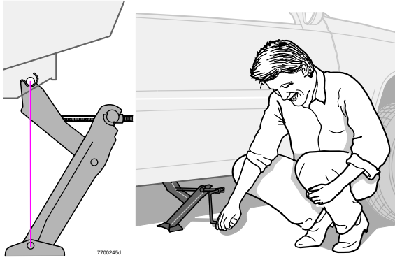
Placez le cric de la façon suivante
