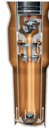
Phase de compression – Piston et bypass = réglage sportif ferme
