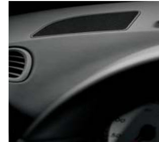
Enceinte néodyme 2,5 cm pour les fréquences aiguës
