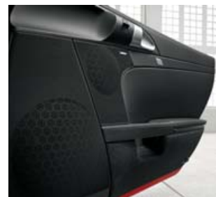
Enceinte néodyme 8,0 cm pour les fréquences moyennes et 20,0 cm pour les graves*
