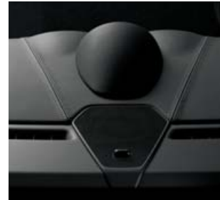
Haut-parleur central 7,0 cm pour les fréquences moyennes (Centerspeaker)
