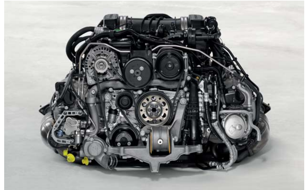
Moteur 6 cylindres à plat 3,4 l du Boxster S
