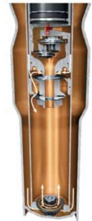
Phase de détente – piston seul = réglage sportif ferme
