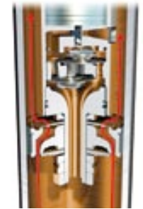
Phase de compression – piston seul = réglage sportif ferme
