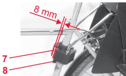
☞ Stringete adesso le viti **7** del supporto **5** con una chiave per viti ad esagono cavo (misura 5) con una coppia di serraggio di 5 Nm.
