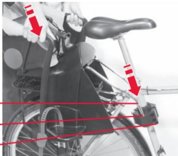
☞ Inserite il seggiolino da bicicletta con le staffe di fissaggio **9** nei fori di arresto **10** finché si blocca.
