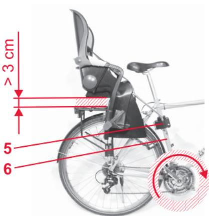
**So positionieren Sie die Halterung **9** richtig am Fahrrad:**
