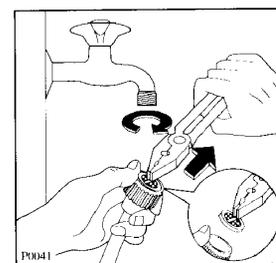
Si l'on remarque que la machine prend plus de temps à se remplir, il est conseillé de contrôler que le filtre du tuyau d'arrivée d'eau ne soit pas bouché. Fermer le robinet de l'eau. Dévisser l'embout du tuyau du robinet. Extraire le filtre de son logement, le nettoyer avec une petite
