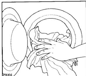
Ouvrir le hublot. Charger les pièces de linge en les introduisant une à la fois dans le tambour. Déplier le plus possible le linge. Fermer le hublot; le bloquer avec soin.
