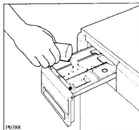
Doser la quantité voulue de détergent dans un gobelet gradué et le verser dans le bac pour le lavage [1].
