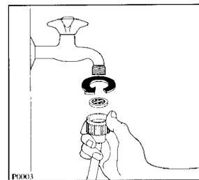
Brancher le tuyau d'arrivée à un robinet fileté à un pas de gaz de 3/4" après avoir interposé le petit filtre livré avec l'appareil.
