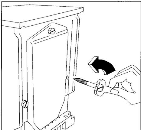
Dévisser (à l'aide de la clé livrée avec l'appareil) la vis arrière droite.
