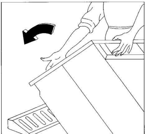
Coucher l'appareil sur le dos, en faisant attention à ne pas endommager les tuyaux.
