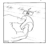
Enfoncer le bouton du thermostat et le tourner sur la température désirée.
