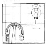
Sur le bord d'un lavabo. Dans ce cas il est nécessaire de veiller à ce que l'extrémité ne puisse pas se décrocher du bord lorsque la machine effectue la vidange. On pourrait, par exemple, l'assurer avec une petite ficelle au robinet, ou l'accrocher au mur.
