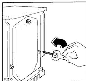
Dévisser à l'aide d'une clé la vis arrière droite.
