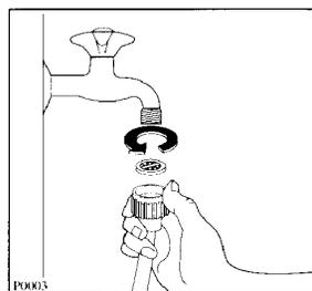
Brancher le tuyau d'arrivée à un robinet fileté au pas de gaz de 3/4" après avoir interposé le petit filtre livré avec l'appareil.
