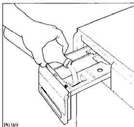
Verser, le cas échéant, l'assouplissant dans le bac ad hoc [III] sans dépasser le niveau MAX.
