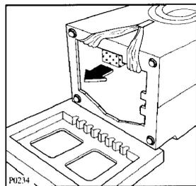
Enlever le bloc de polystyrène du fond de la machine; il n'est pas nécessaire de le conserver.
