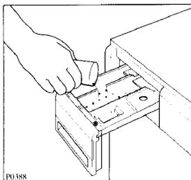
Doser la quantité voulue de détergent dans un gobelet gradué et le verser dans le bac pour le lavage [II].
