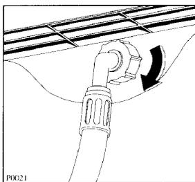
L'autre extrémité du tuyau d'arrivée, du côté de la machine, peut être orientée dans n'importe quelle direction. Dévisser un peu la bague de serrage, tourner le bout du tuyau et revisser solidement la bague.
