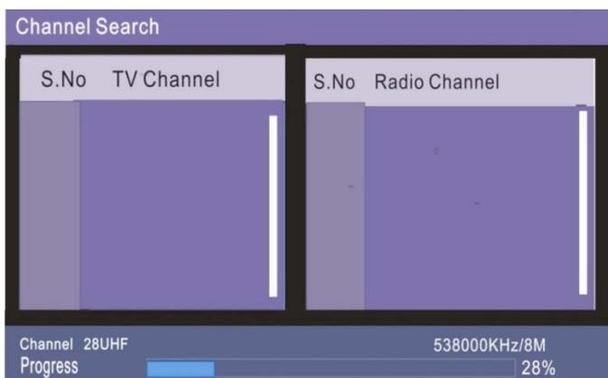
**RECHERCHE MANUELLE :** Appuyez sur ENTRER pour établir la recherche manuelle, et utilisez  $\blacktriangleleft$  /  $\blacktriangleright$  pour sélectionner la chaîne de démarrage de la recherche manuelle.
