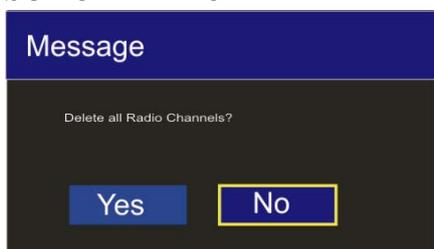
Utilisez la touche  $\blacktriangledown$  /  $\blacktriangle$  pour sélectionner SUP CH RADIO et appuyez sur OK pour ouvrir une boîte de dialogue permettant de confirmer ou non la suppression. Sélectionnez NON pour revenir à la page précédente.
