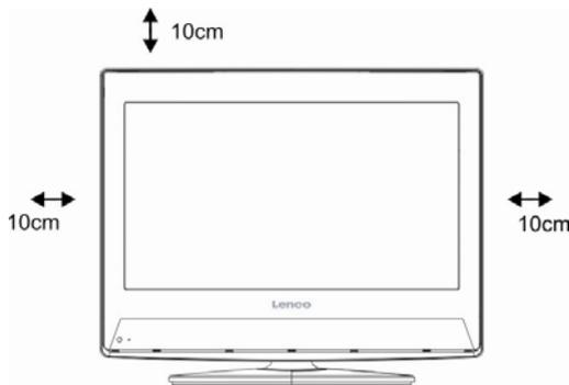
Placez votre téléviseur LCD sur une surface solide pouvant supporter le poids du téléviseur LCD. Pour éviter tout danger, ne placez pas le téléviseur LCD à proximité d'une source d'eau ou de chaleur, (telle qu'une lampe, une bougie, un radiateur). Ne bloquez pas les ouvertures de ventilation situées au dos du téléviseur LCD.
