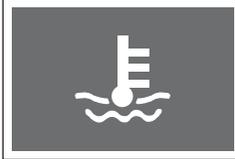
Si la température du liquide de refroidissement du moteur est anormalement élevée, le témoin de surchauffe du moteur clignote et un vibreur retentit. Dans ce cas, arrêtez le véhicule dans un endroit sûr et laissez le moteur refroidir. Pour plus
