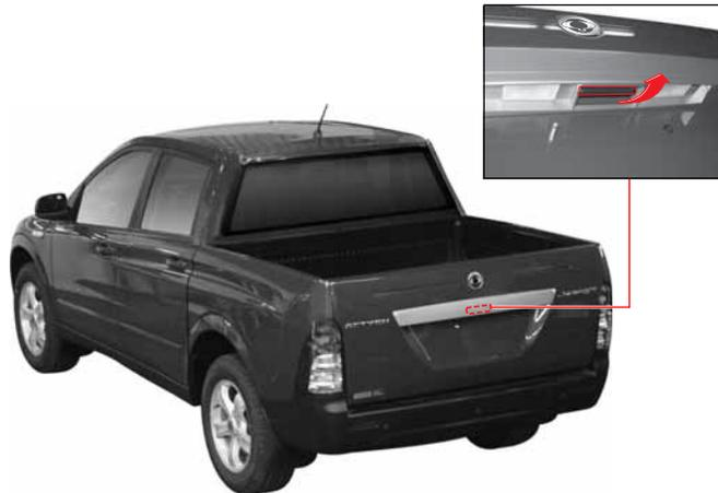
Pour ouvrir le hayon, tirez le levier pour déverrouiller le hayon et abaissez-le lentement des deux mains.
