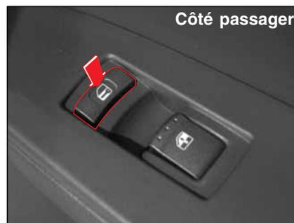
Quand le commutateur de verrouillage/déverrouillage de porte est enfoncé pendant que toutes les portes et le hayon sont verrouillés, toutes les portes seront déverrouillées. Quand le commutateur est enfoncé à nouveau, toutes les portes sont verrouillées.
