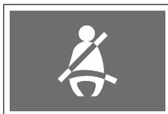
Quand le commutateur de contact est mis sur "ON" et que la ceinture de sécurité du conducteur n'est pas bouclée, le témoin de rappel s'allume et le vibreur retentit pendant 6 secondes. Ce rappel s'arrête quand le conducteur boucle sa ceinture même pendant la période de fonctionnement.
