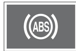
Ce témoin s'allume quand le commutateur d'allumage est sur "ON" et doit s'éteindre si le système est normal.
