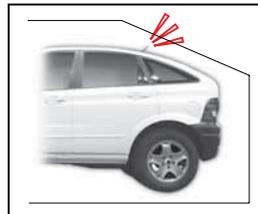
**L'intervalle d'alarme se réduit avec la proximité de l'obstacle.**
