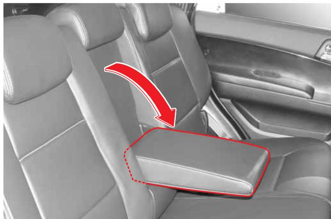
L'accoudoir arrière se trouve au centre du siège arrière. Baissez l'accoudoir pour l'utiliser. Sinon rangez-le.
