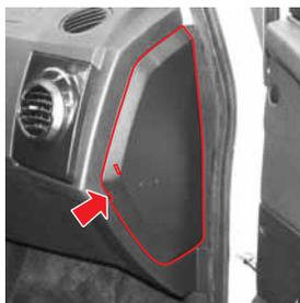
2 La boîte à fusibles se trouve du côté droit du panneau d'instruments. Pour accéder à la boîte intérieure à fusibles, ouvrez la porte du passager et déposez le couvercle de la boîte au moyen d'un tournevis.
