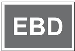
Ce témoin s'allume quand le commutateur d'allumage est sur "ON" et doit s'éteindre si le système est normal. Si le système EBD est anormal, le témoin EBD reste allumé.
