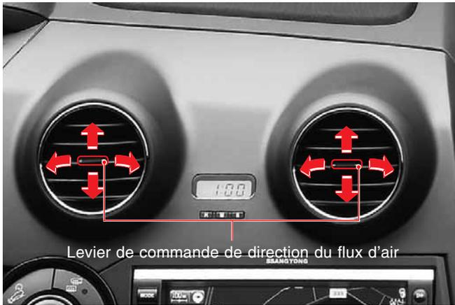
Vous pouvez régler la direction du flux d'air en déplaçant le bouton horizontalement ou verticalement.
