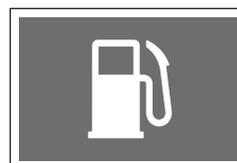
Ce témoin indique que le carburant va bientôt manquer. Le moment de l'éclairement du témoin varie en fonction des circonstances de fonctionnement du véhicule et de l'état de la route. N'attendez pas que le voyant soit allumé pour refaire le plein. Il est recommandé de rajouter du carburant dès que ce témoin s'allume.
