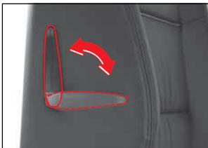
Faites tourner le levier vers l'avant pour augmenter le soutien lombaire. Faites tourner le levier vers l'arrière pour diminuer le soutien.
