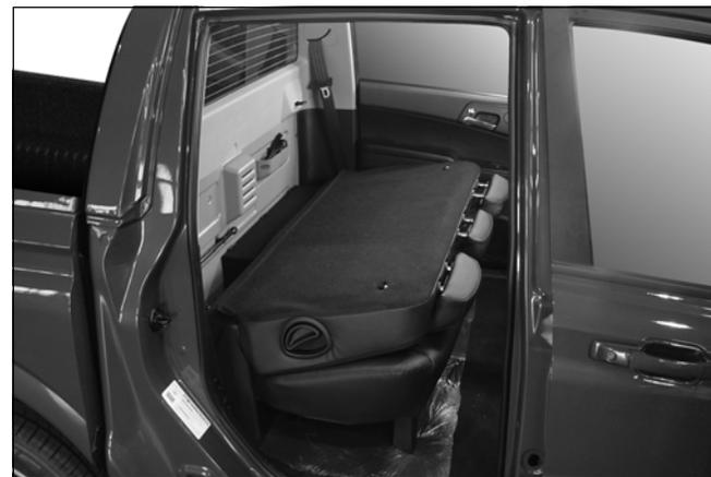
2. Après avoir déverrouillé les dossiers de siège, repliez-les vers l'avant du véhicule.
