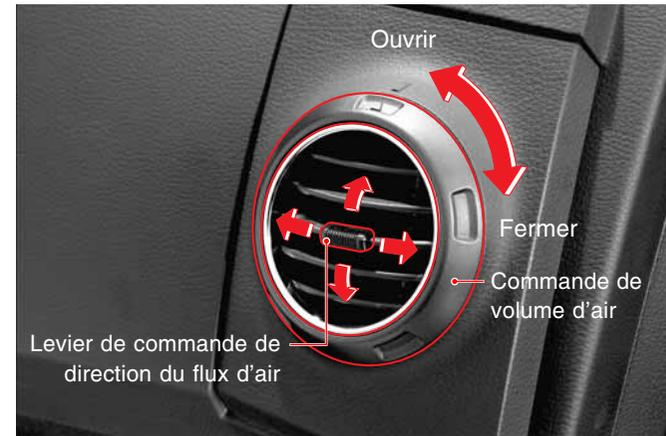
Vous pouvez régler la direction de l'air en déplaçant le levier de commande de la bouche d'air.
