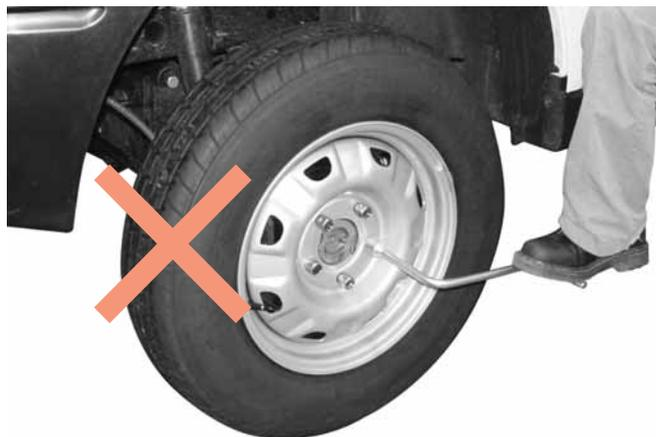
Un serrage excessif pourrait endommager les écrous de roue. Ne serrez pas excessivement les écrous de roue en pressant la clé d'écrou de roue au moyen des pieds ou d'un tuyau d'assistance.
