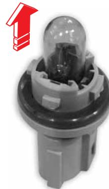
5. Déposez l'ampoule du logement.
