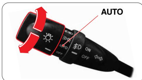
Ce capteur de lumière automatique et de pluie détecte l'intensité de la lumière extérieure pour allumer les projecteurs et les feux arrière ou les éteindre automatiquement quand le commutateur d'éclairage est mis en position "AUTO" (automatique).
