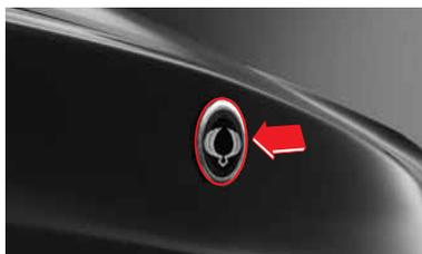
Après avoir déverrouillé le hayon à l'aide du commutateur d'ouverture de hayon ou de la clé de contact, soulevez le hayon pour l'ouvrir complètement. Pour fermer le hayon, tirez sur la poignée pour le rabattre. Poussez ensuite le hayon pour le fermer complètement.
