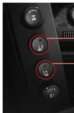
**Commutateur de chauffage du siège conducteur**
