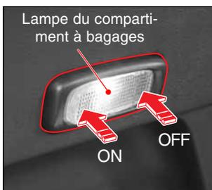
Si la partie ON (marche) est pressée, la lampe s'allume; si la partie OFF (arrêt) est pressée, la lampe s'éteint.
