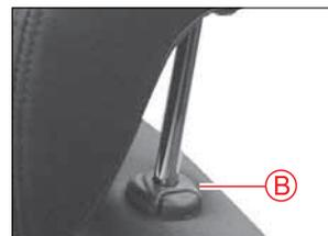
Pour lever l'appuie-tête, tirez vers le haut sans appuyer sur le bouton de déverrouillage. Pour abaisser l'appuie-tête, pressez le bouton de déverrouillage (B) placé au sommet du dossier du siège et poussez l'appuie-tête vers le bas.
