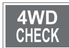
Ce témoin s'allume quand le commutateur d'allumage est sur "ON" et doit s'éteindre si le système est normal. Si le témoin "4WD CHECK" reste allumé, faites vérifier le système 4WD (4 roues motrices) par le distributeur Ssangyong ou l'atelier agréé par Ssangyong le plus proche.
