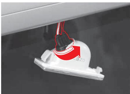
3. Retirez le boîtier de la lampe en tournant le connecteur.
