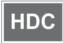
Quand le bouton HDC est pressé une fois, l'HDC est prêt à l'usage. Le témoin vert d'HDC sur le panneau de commande s'allume. Quand le bouton est pressé à nouveau, l'HDC est désactivé et le témoin s'éteint.
