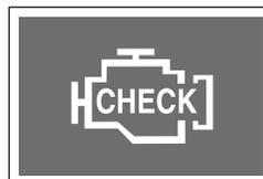
Si le témoin reste allumé ou s'allume en conduisant, certains éléments de contrôle du moteur y compris les capteurs et dispositifs sont défectueux.
