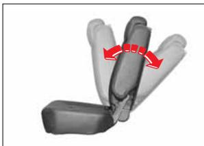
Pour incliner le dossier de siège, pousser le levier (A) de déverrouillage du dossier vers l'arrière du véhicule. Ce levier se trouve sur le côté du dossier.
