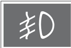
Lorsque les projecteurs ou les feux arrière sont allumés, les feux antibrouillard s'allument si le commutateur de feux antibrouillard est mis En fonction. Le témoin de feu antibrouillard s'allume alors au tableau de bord.
