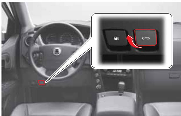
1. Pour ouvrir le capot moteur, tirez le bouton de déverrouillage situé sous le côté gauche du volant pour déverrouiller le capot moteur.
