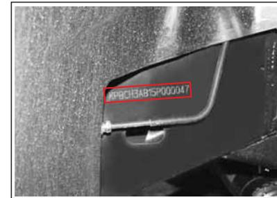
Le numéro de châssis est marqué sur le cadre derrière la roue arrière droite.
