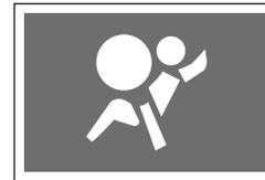
Quand le contact est allumé, ce témoin s'allume et doit s'éteindre ensuite, pour confirmer que l'airbag est opérationnel.
