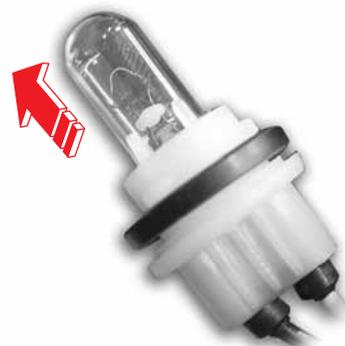
4. Déposez l'ampoule.
